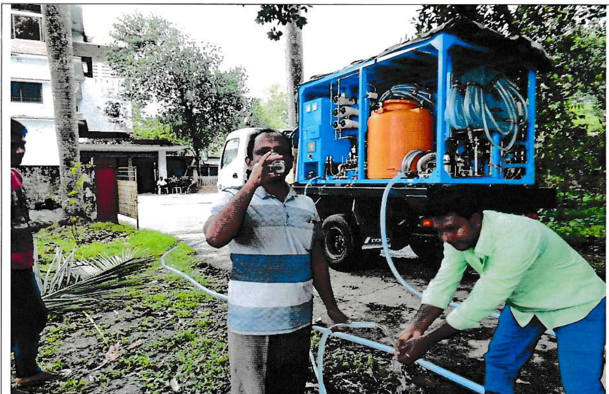
(চিত্রঃ-৫) ২ টন ট্রাক মাউন্টেড মোবাইল স্যালাইন ওয়াটার ট্রিটমেন্ট প্ল্যান্ট এর পানি পরিশোধন ব্যবস্থাপনার চিত্র
