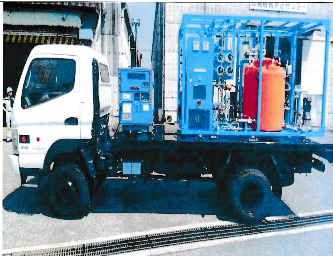
(চিত্রঃ-৫) ২ টন ট্রাক মাউন্টেড মোবাইল স্যালাইন ওয়াটার ট্রিটমেন্ট প্ল্যান্ট এর পানি পরিশোধন ব্যবস্থাপনার চিত্র
